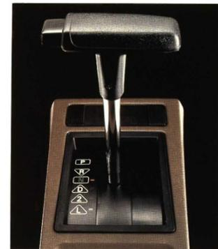
Das liegt daran, daß ihr Drehmomentwandler mit extrem geringem Schlupf arbeitet und der Wirkungsgrad deshalb besonders hoch ist. Das heißt: der Kraftverlust ist äußerst gering und der Kraftstoffverbrauch entsprechend niedrig. Außerdem schaltet die Öko-Automatic so intelligent, daß sich der Motor je nach Fahr situation immer im günstigsten Drehzahlbereich bewegt. Die erfreuliche Folge: geringer Verbrauch bei äußerster Schonung für den Motor. Und das alles ganz automatisch.
